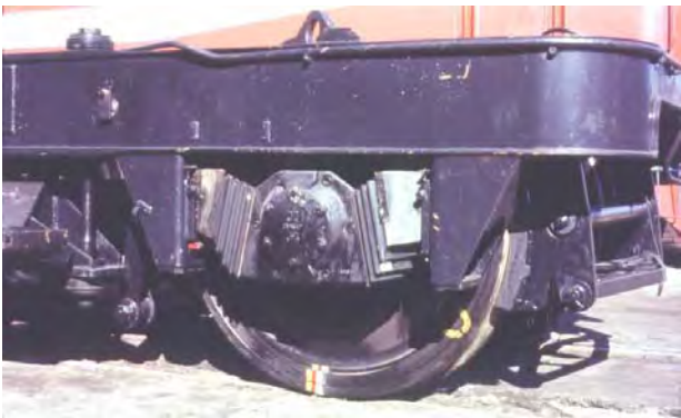
Слика 1. Гумено-метални елементи примарног огибљења у раму обртног постоља електричне локомотиве серије 441
