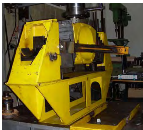
Слика 2. Модел и реални испитни за мерење крутости пара гумено-металних елемената у три правца
