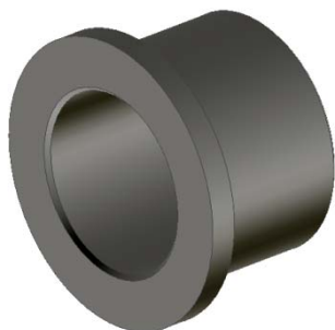
Slika 13. 3D model ležišne čaure dobijene u Autodesku Inventoru
