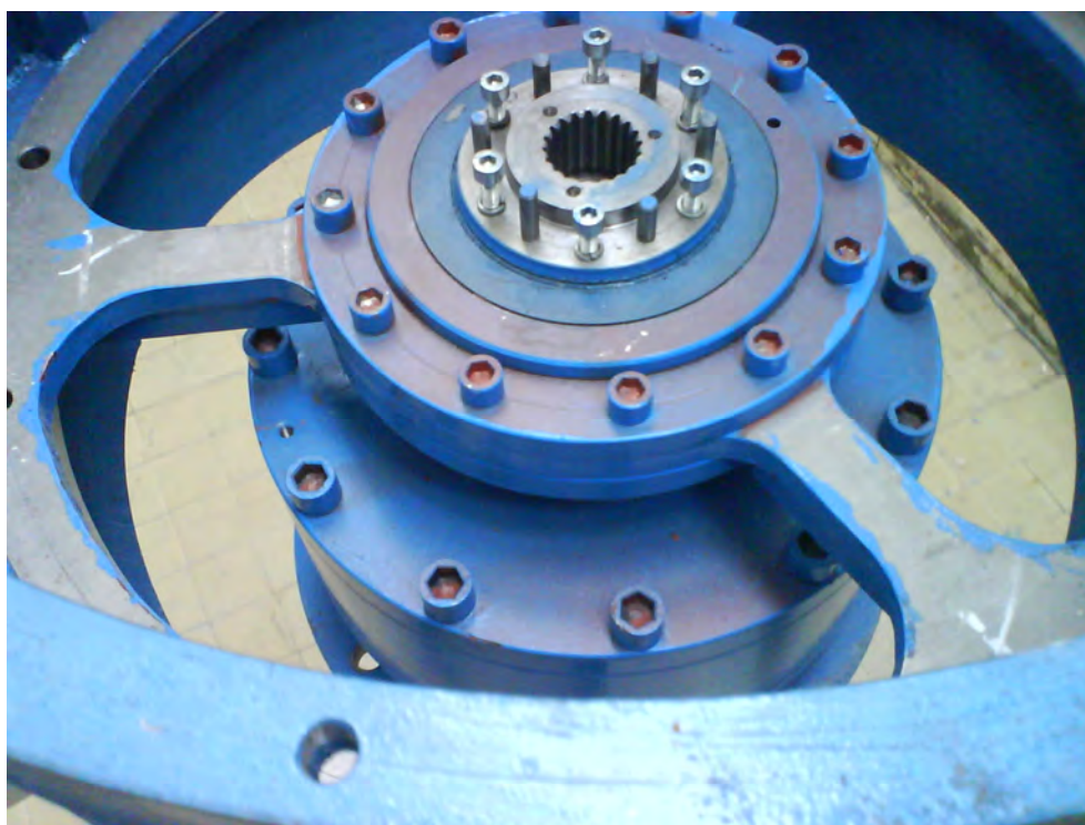
Planetni prenosnik ugrađen u bazni podsklop mašine
