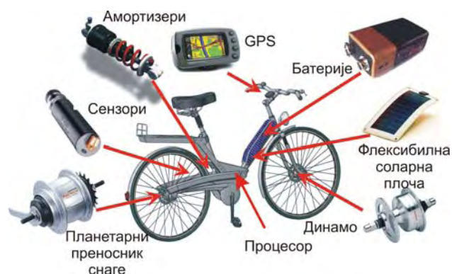
Слика 5: Бицикл са уграђеним LCU системом
