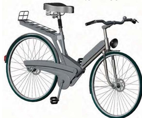
Слика 1: Тродимензионални модел креиран CAD апликацијом SolidWorks са имплементацијом материјалности саставних делова
