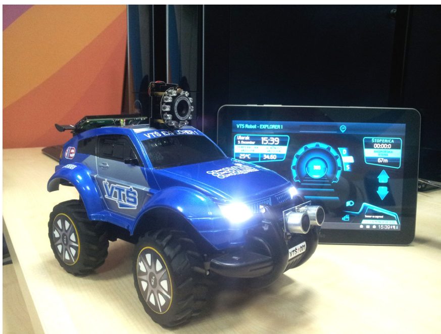
Slika 9. Realizovano vozilo i aplikacija za Android uređaj
