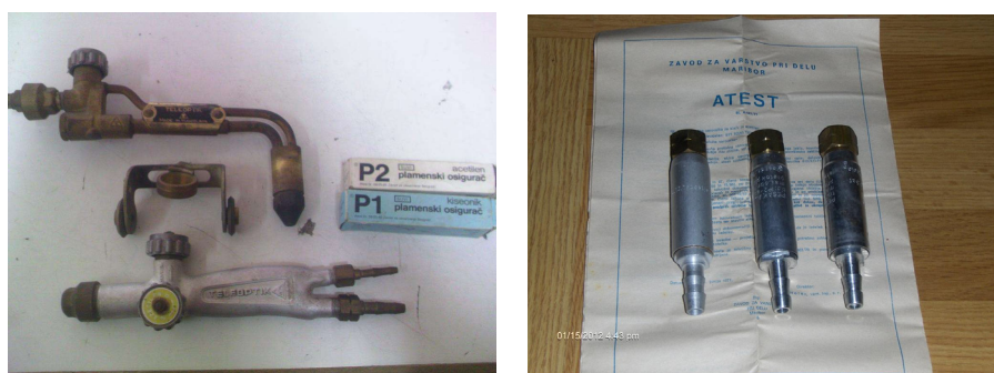
Slika 9. – Mere bezbednosti pri radu sa gorionikom – plamenski osigurač
