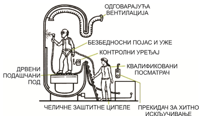
zavarivanje u ograničenm prostorima
