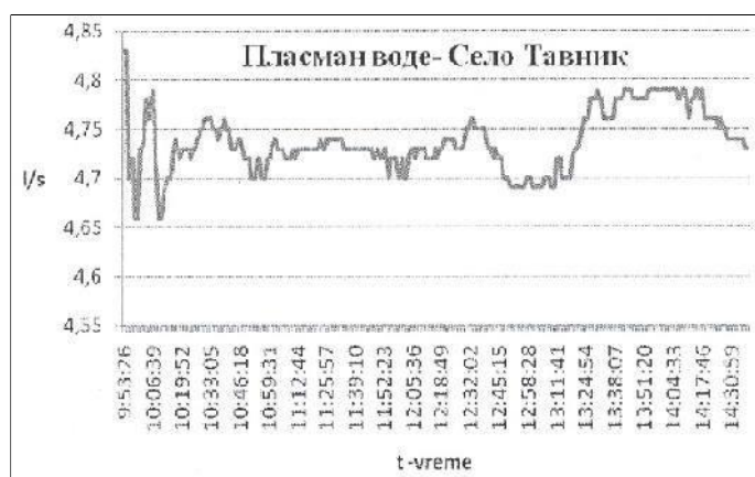
Слика 3. Резултати мерења протока при пласману воде
