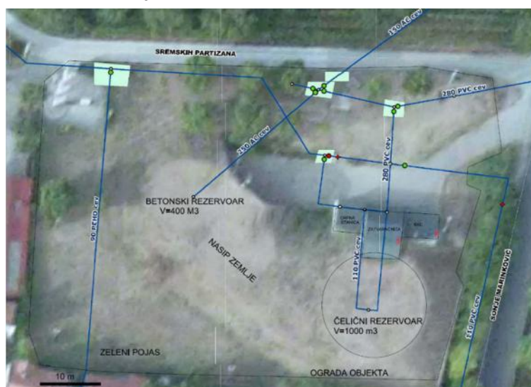
Slika 1. Šematski prikaz položaja čeličnog rezervoara
