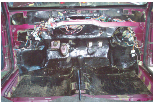
Sl.7. Inovirana izolacija pregradnog zida. U daljem tekstu na dijagramima naznačena kao pz .
